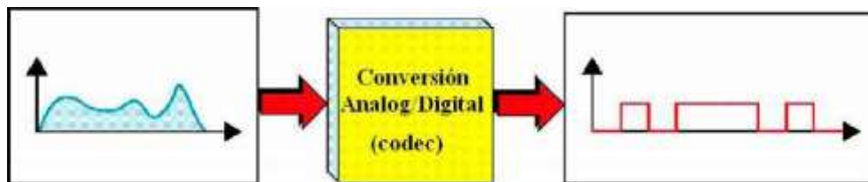
Figura 2.3.30 Conversión Analógico a Digital.
